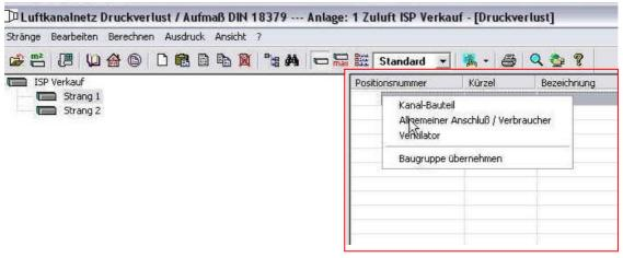
In diesem Menü können der Luftvolumenstrom und der Druckverlust für den Verbraucher eingeben werden.
